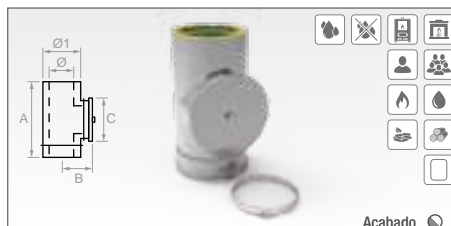
Tramo inspección (Inox 316-Interior / Inox 304-Exterior)
